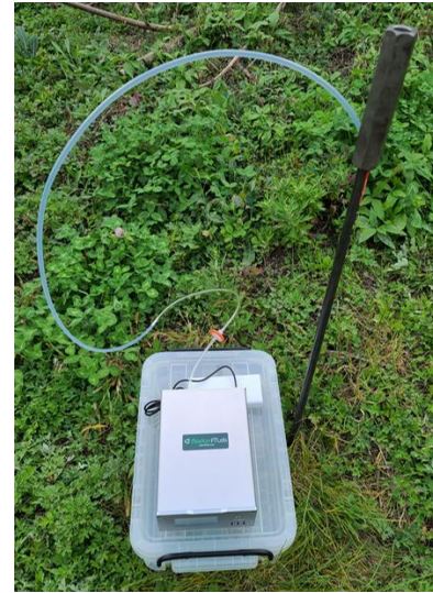
[사진 2] Radon in Soil 측정
